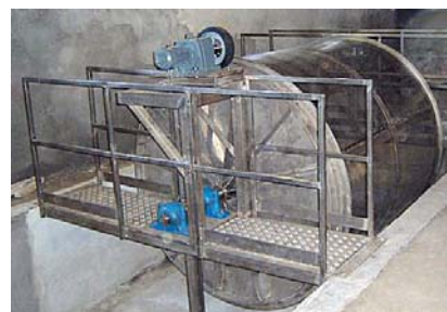
Filtru fix de capacitate mare, de max 1200 m 3 /h
